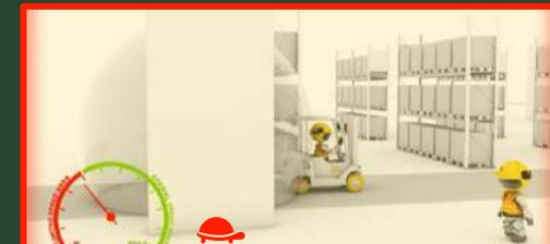
Cuando el vehículo pasa por el EGOpro Safe Zoning GATE, cambia sus funciones y las mantiene hasta que vuelve a pasar por la puerta virtual. Además de definir la performance del vehículo, el sistema puede interactuar con el ambiente alrededor.
