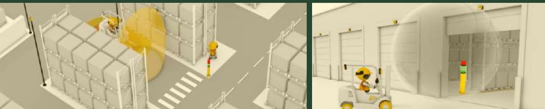
EGOpro Safe Zoning SPOT controla de manera segura pasos peatonales, puerta seccionales, puntos ciegos e intersecciones al crear una área delimitada dentro de la cual se puede definir:
